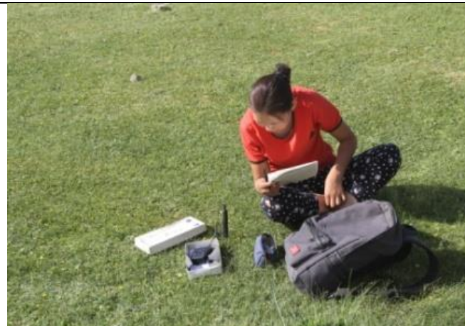
Abb. 4 G.Yondon misst die Temperatur und Feuchtigkeit des Bodens
