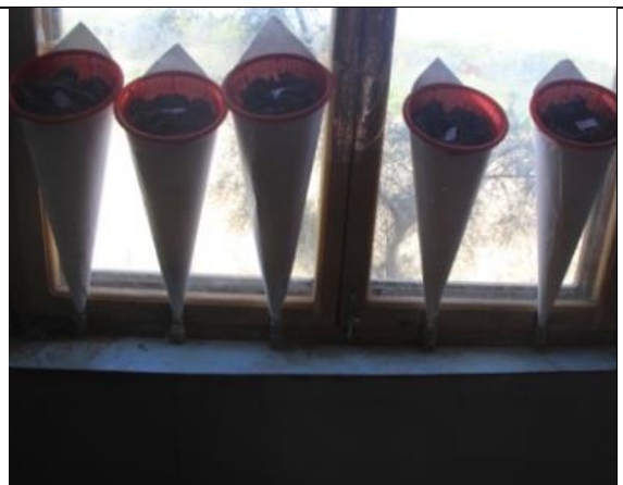
Abb. 5 Die Bodenproben werden waehrend der Feldarbeit mit einem einfachen Eklektor gefiltert. Aussortierte Organismen warden in Alkohol fixiert.
